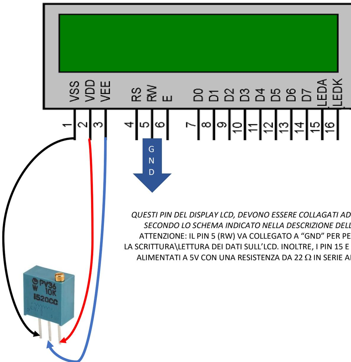
Schema di montaggio con LCD standard HD44780
