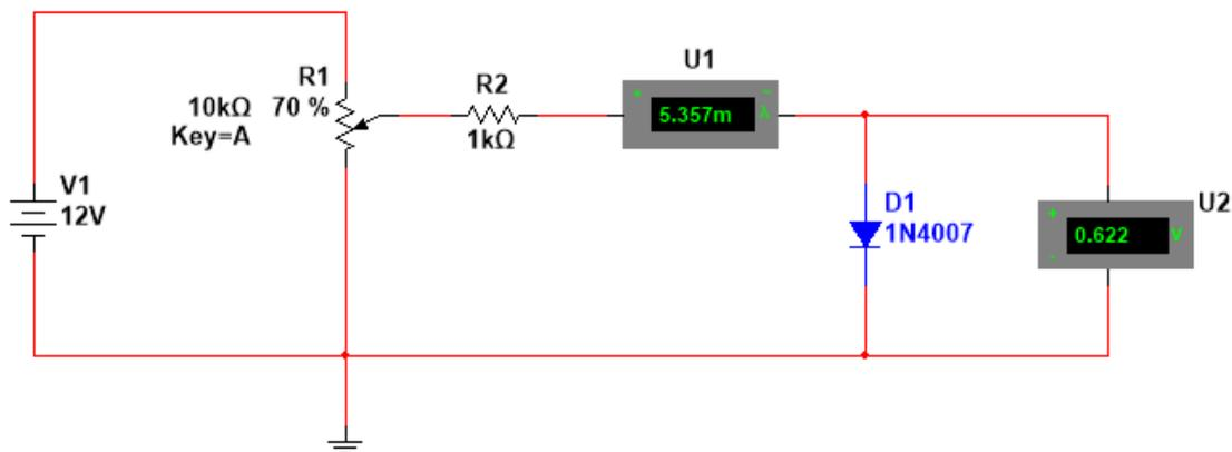
Montare il circuito e regolare opportunamente il potenziometro **R1** per rilevare la corrente  $I_f$  che circola nel circuito ad ogni step di tensione  $V_f$  completa la tabella sottostante, riporta i dati su un foglio di calcolo (es: excel) e realizza il grafico. Per una anteprima puoi usare la carta millimetrata.
