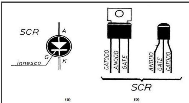
I diodi S.C.R. sono conosciuti anche con il nome di **Tiristori**. Essi hanno la particolarità di entrare in conduzione quando il segnale di innesco applicato al terminale di **Gate** supera una determinata soglia relativa alla tensione e corrente minima di conduzione tra **Anodo-Katodo**. Tali valori vengono determinati dal costruttore del dispositivo, identificabile attraverso la sigla del componente e, vengono letti nel relativo **Data Sheet**. Lo stato di
